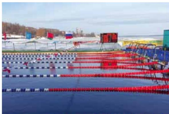
**Бассейн для зимнего плавания представляет собой участок акватории открытого природного водоема, поверхность которого ограничена периметром изо льда (прорубь), понтонов или свайных конструкций длиной 25 метров, с обеих сторон оборудованный лестницами и щитами для разворота.**
